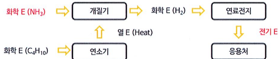
그림. 수소 생산을 위한 에너지 변환 Flow Diagram
