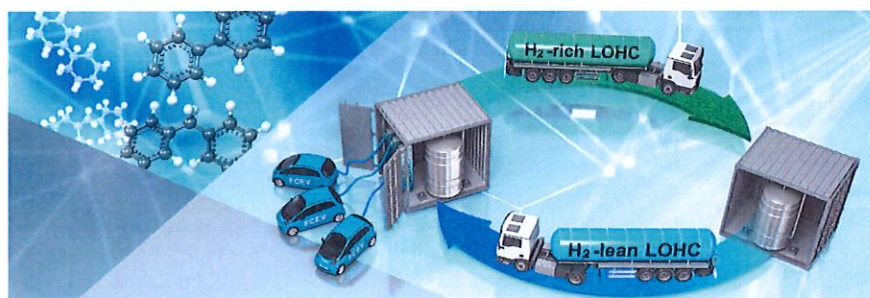
그림. 액상유기수소운반체(LOHC)가 수소 운반체로 이용되는 모식도
