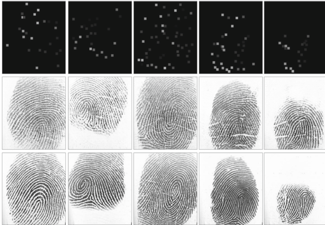
그림 8. 재구성된 지문 이미지, 맨 위부터 각각 특징점 맵(Minutia map), 본 연구팀의 방법으로 재구성한 지문 이미지, 해당 특징점 맵을 지닌 원본 지문 이미지
