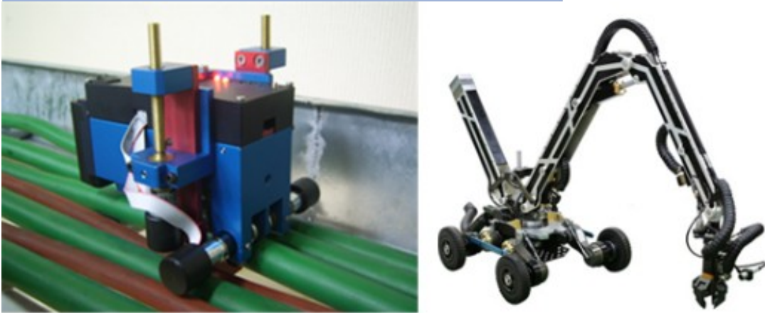
그림 14 세계 최초 원전 케이블 열화상태 진단 로봇(좌)과 GIBBON(우)
