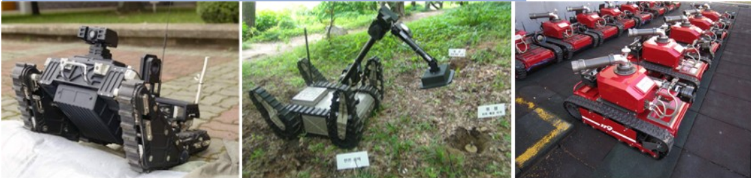
그림 2 위험 작업 로봇(좌), 지뢰 제거 작업 로봇(중), 소방 로봇(우)
