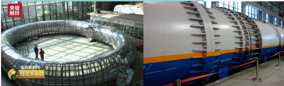
그림 7. 중국 서남교통대의 원형 및 직선형 진공튜브철도 실험장치
