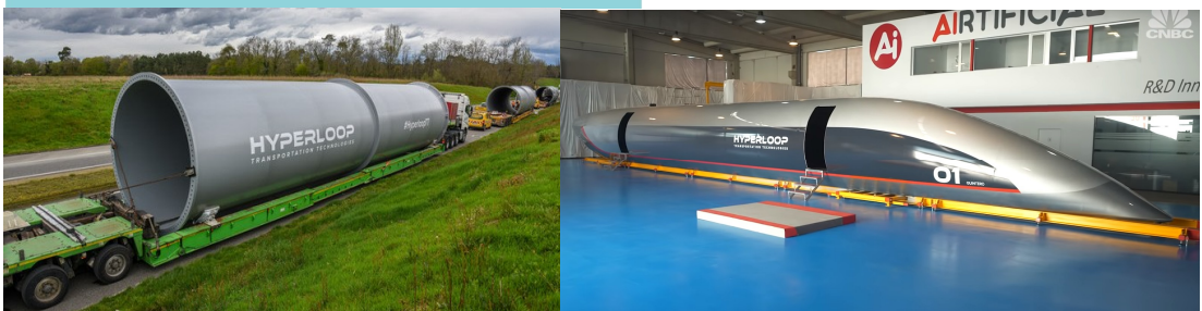
그림 4. HTT의 아진공 튜브 및 캡슐차량 모형
