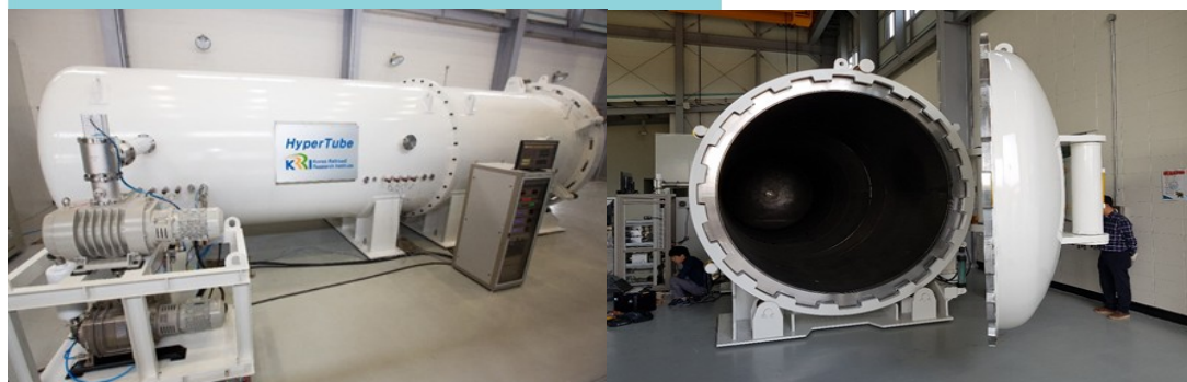
그림 15. 하이퍼튜브 HTX의 아진공 기밀튜브 시제품
