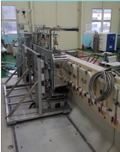
그림 17. HTX용 냉동기 분리형 고온 초전도전자석 시제품 및 성능시험
