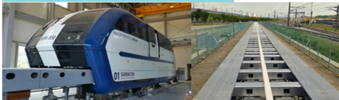
그림 16. 550km/h급 LSM 자기부상차량 및 단거리 시험선로
