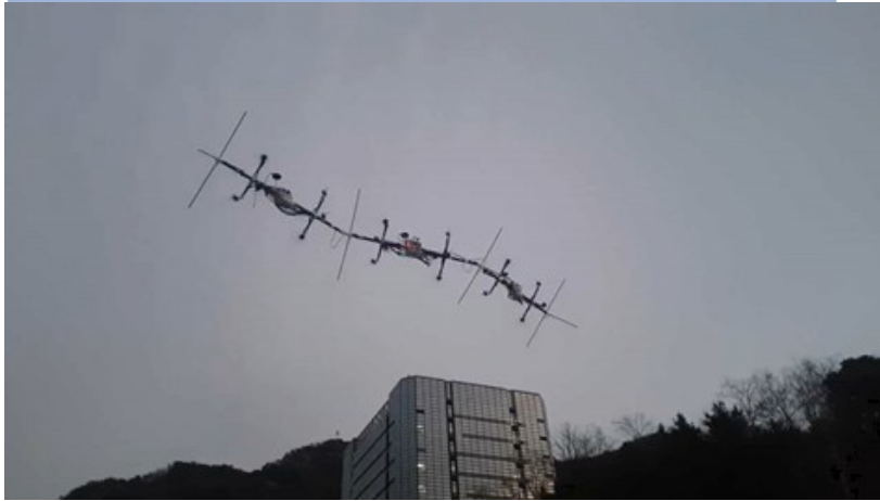
그림 11. 기계적으로 연결된 군집비행로봇 LASDRA 자율비행
