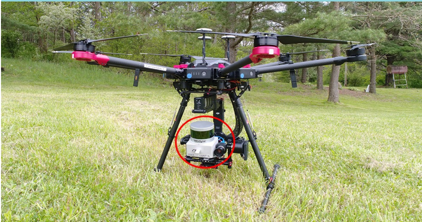
그림 15. 멀티콥터형 무인 드론에 탑재된 카메라 및 라이다 센서 모듈
