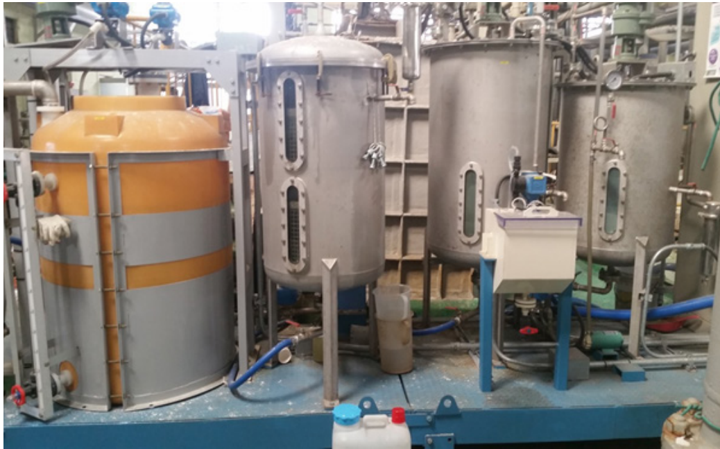
그림 17. 안산 도금 조합 0.5L/일 규모의 개발 나노 흡착제 적용 연속 운전용 파이롯트 장치
